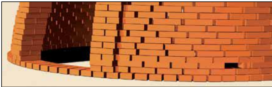
Figura 24. Forma de colocar los ladrillos
