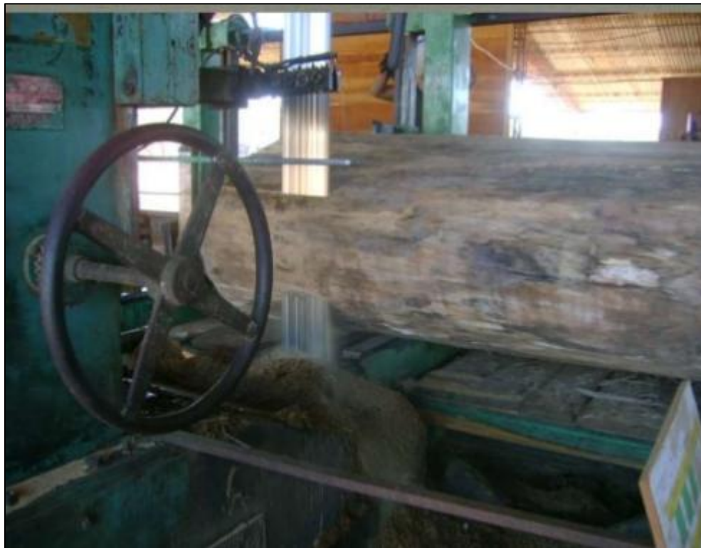
Figura 32. Uso del agua en el proceso de corte
