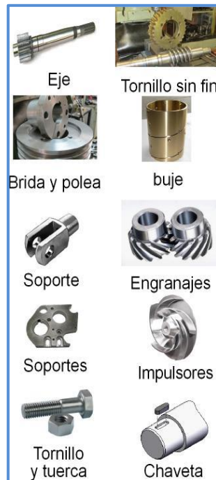
Figura 58. Piezas metálicas con mayor frecuencia de fallo
