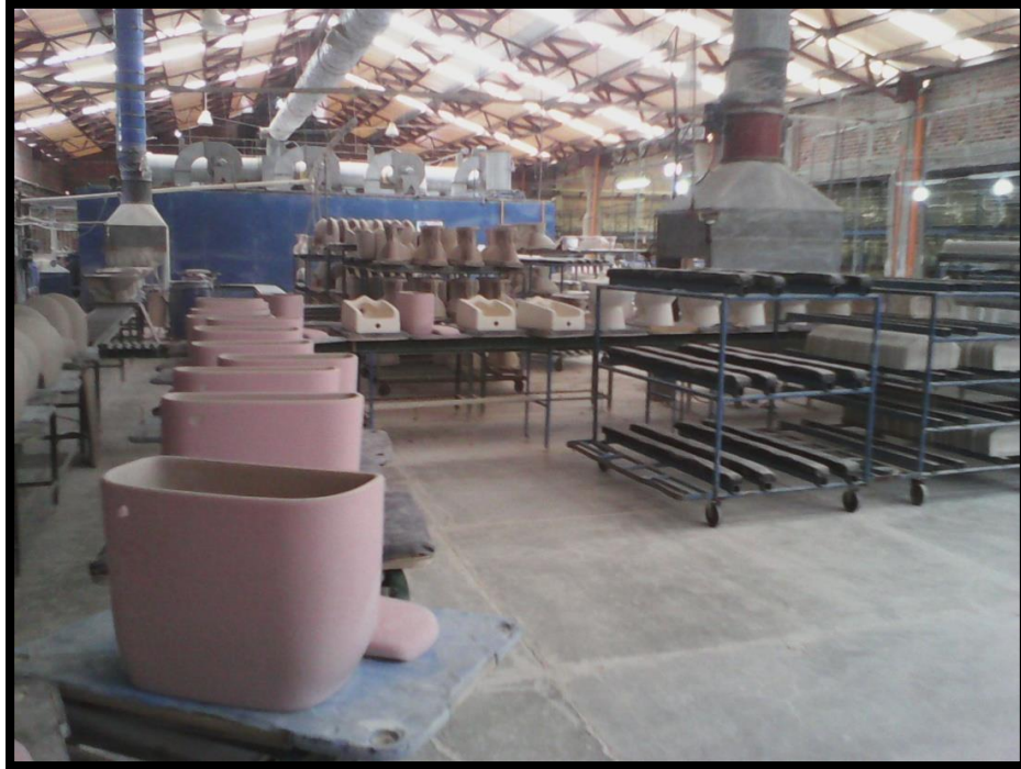
Figura 40. Piezas esmaltadas en carril. Nueva área primera inspección.
