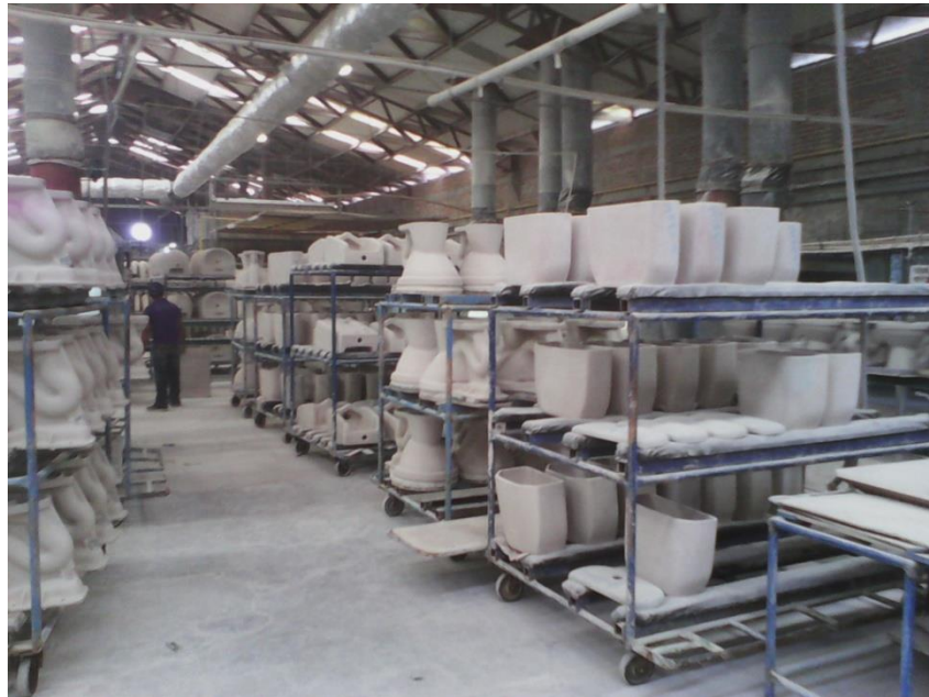
Figura 10. Saturación de piezas. Área de primera inspección
