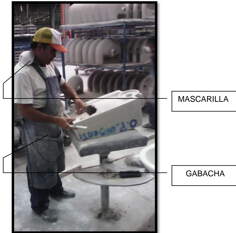
Figura 60. Equipo de seguridad actual primera inspección
