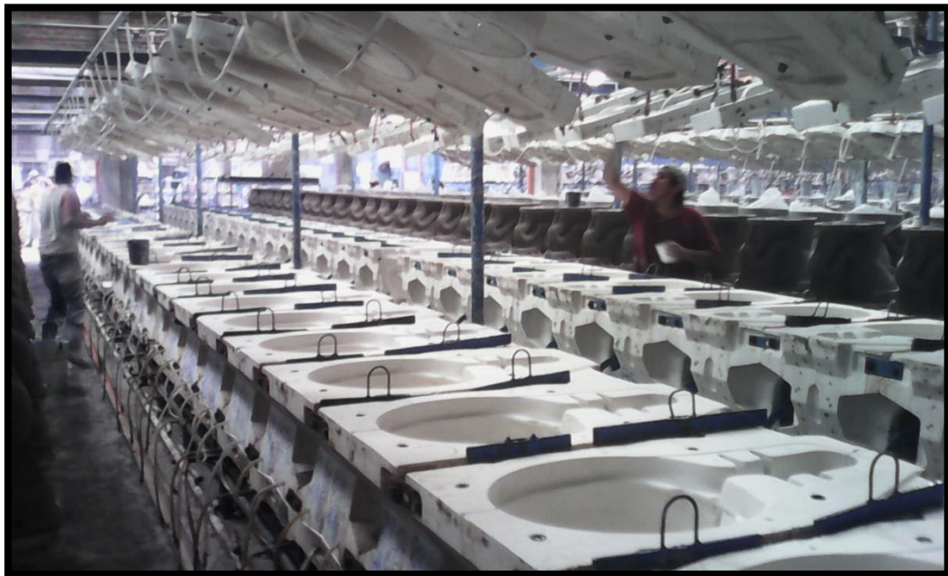
Figura 36. Moldes del área de vaciado
