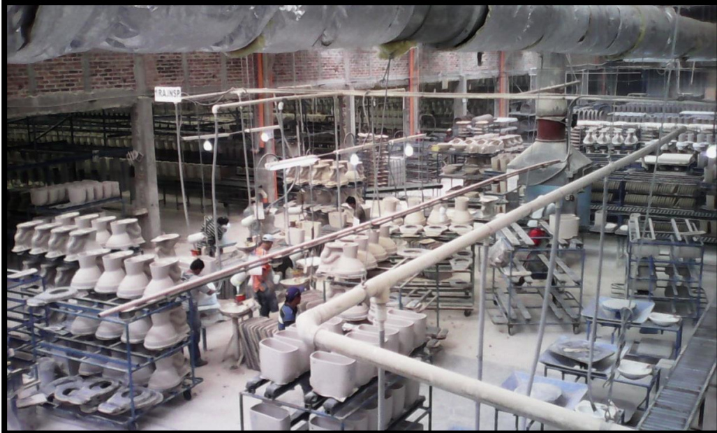
Figura 39. Área de primera inspección y esmaltado. Diseño anterior
