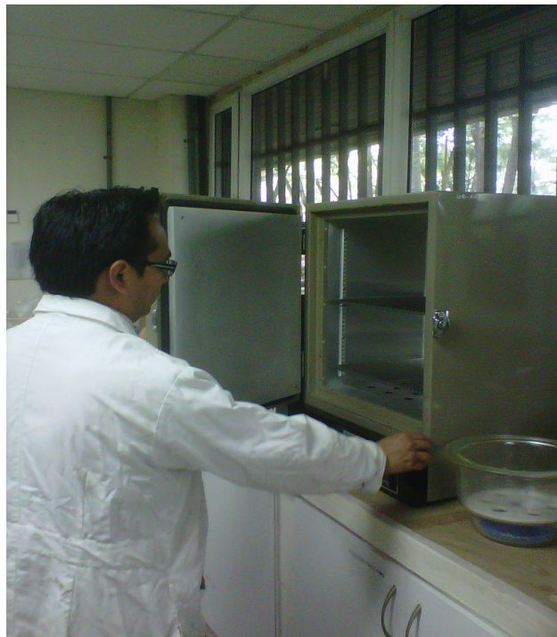
Figura No. 6 Colocación de los filtros dentro del horno durante el procedimiento de “pesaje-equilibrio” a veinticuatro horas.
