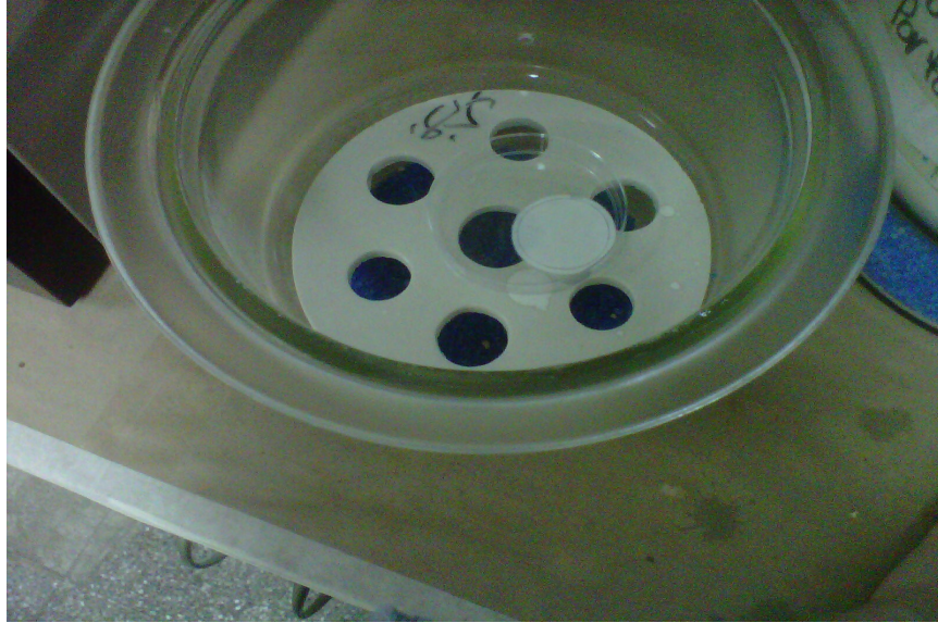
Figura No. 5 Filtro colocado dentro de la desecadora previo a su pesada.
