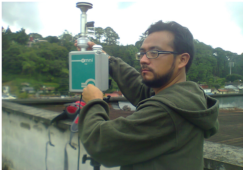
Figura No. 31 Muestreo en la estación P0502 (Casa Particular, Cobán).
