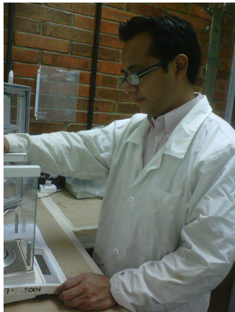
Figura No. 3 Determinación de la masa inicial de los filtros.
