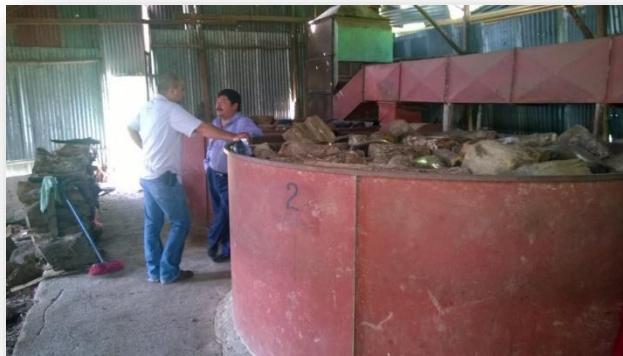
Figura 27. Secadora que ocupa como base leña y un motor monostático para impulsar el aire caliente al recipiente donde se coloca el producto.
