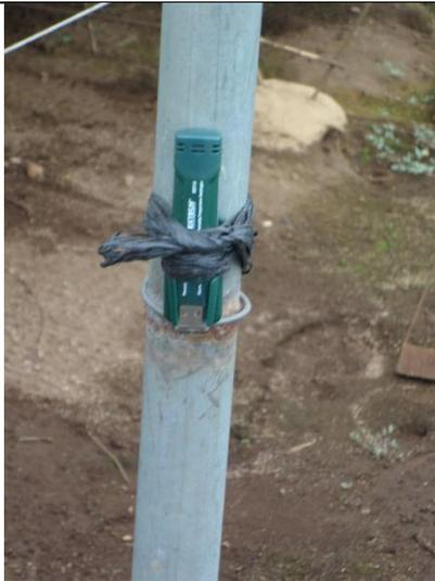
g) Medidor de temperatura y HR
