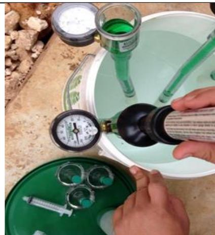
d) Calibración de tensiómetros
