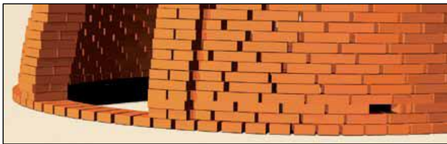
Figura 24. Forma de colocar los ladrillos
