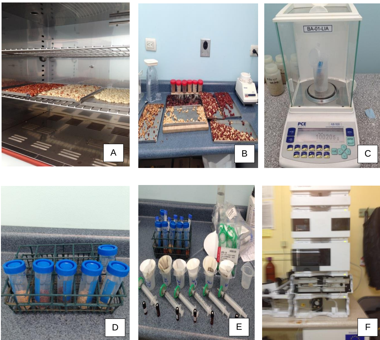
Figura 17. Análisis en el laboratorio: A. Secado de granos. B. Molido de granos. C. Pesado de muestra. D. Muestras centrifugadas. E Extracción de muestras. F Aparato de HPLC.
