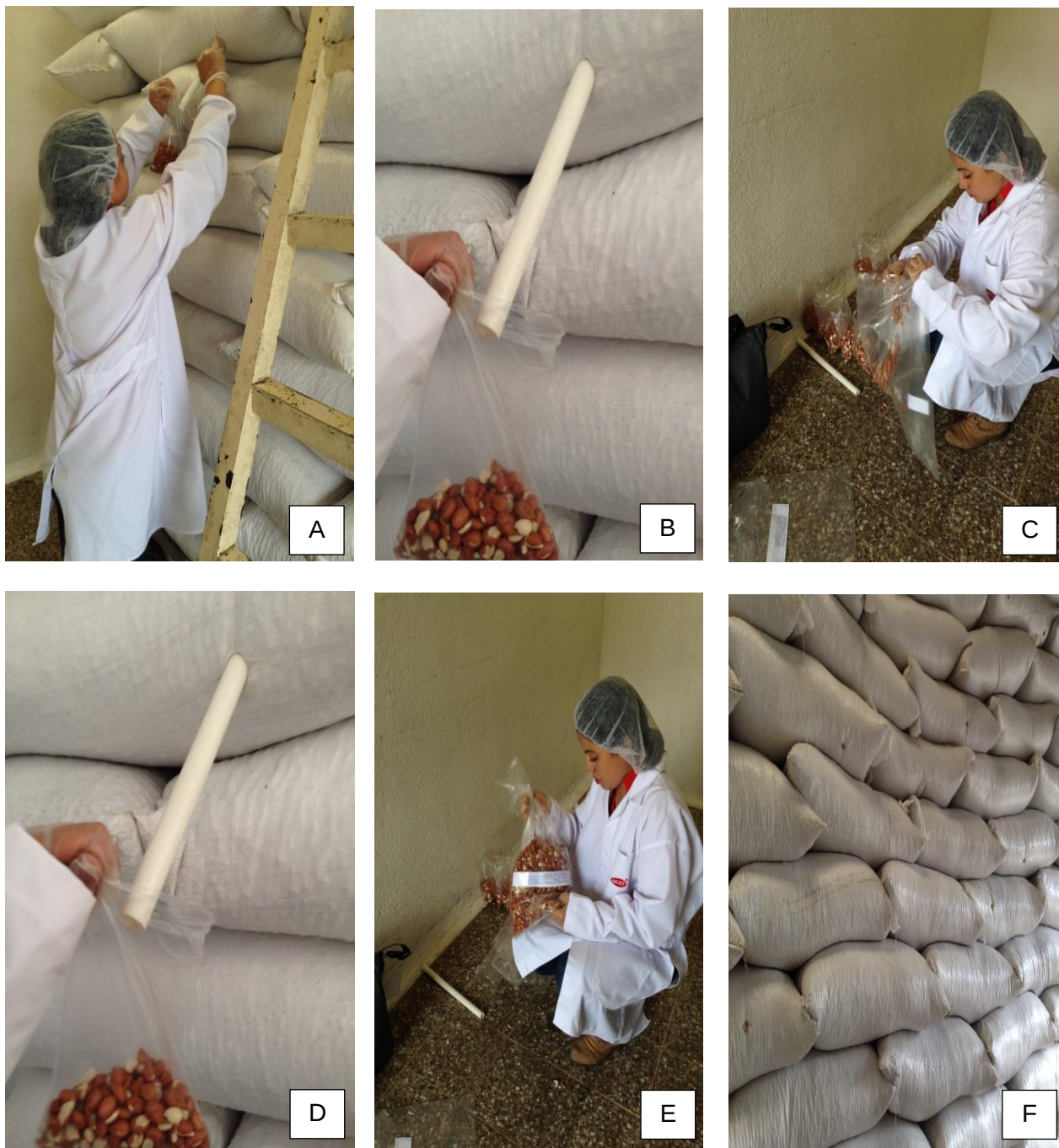
Figura 16. Toma de muestras: A. Inicio de la toma de muestra. B. Ingreso del tubo. C. Recepción de la bolsa. D. Llenado. E. Conformación de la muestra madre. F Sacos de maní en bodega
