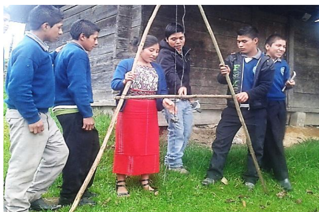
Figura 35. Calibración del nivel tipo A.
