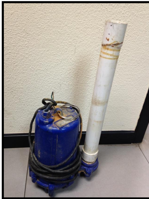
Figura 20. Bomba para retorno de lodos tipo sumergible.
