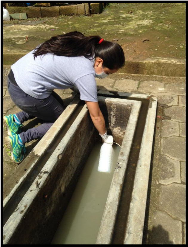
Figura 21. Toma de muestra de agua residual, PTAR Chichorin.
