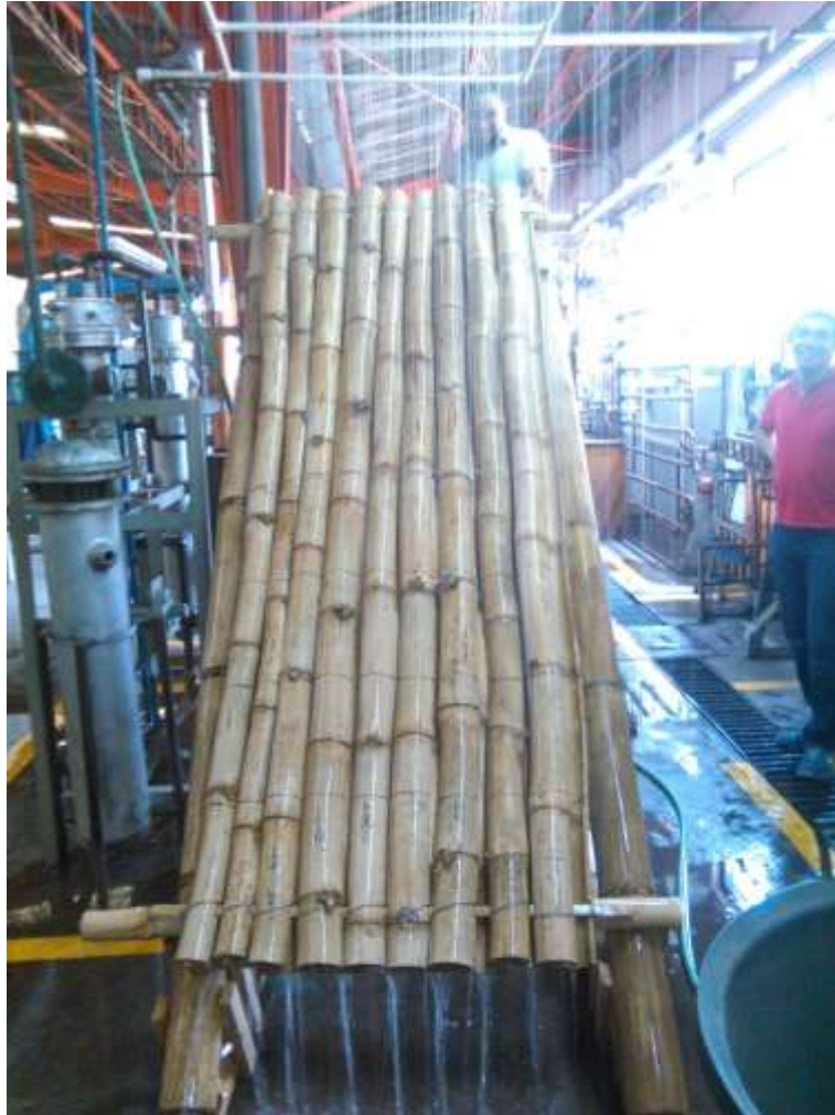
Figura 19. Realización de ensayo de permeabilidad del sistema de cubierta de techo elaborado con bambú
