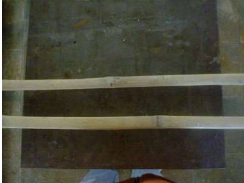
Figura 14. Pasador elaborado con bambú visto en su sección longitudinal
