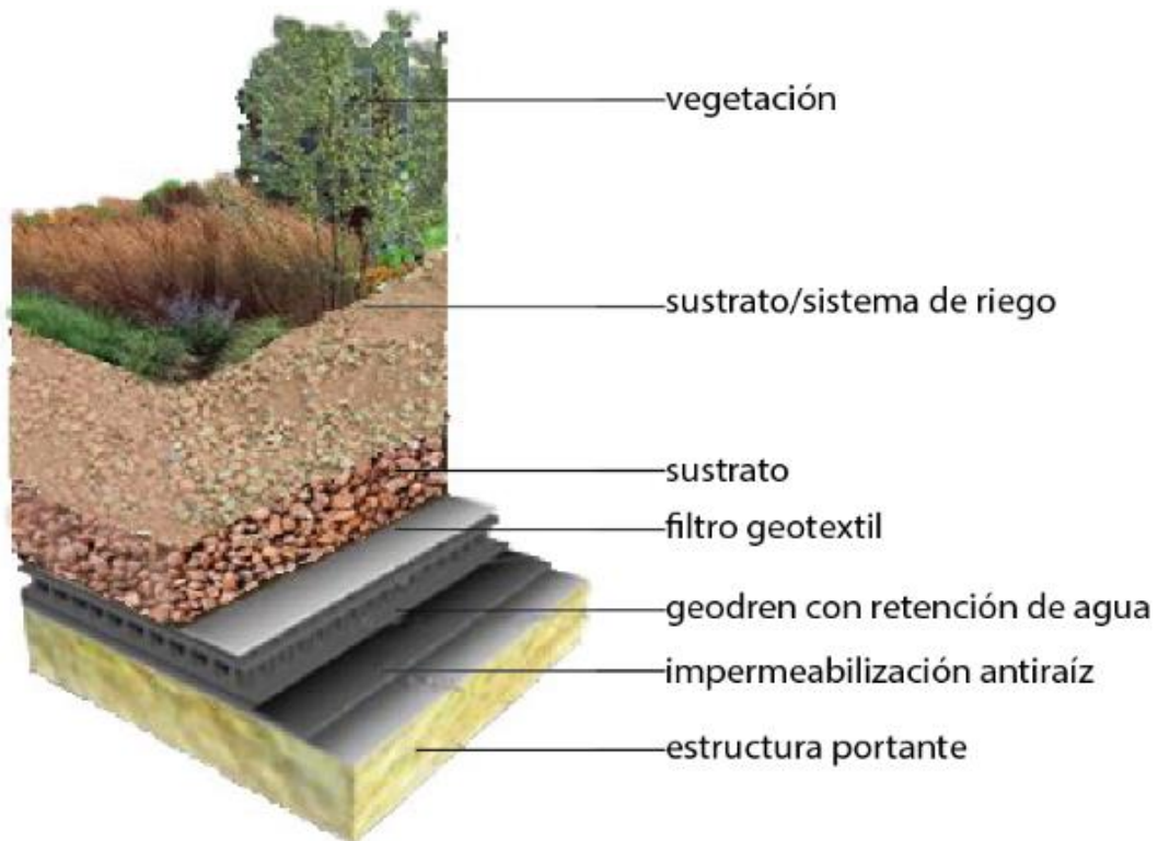
Figura 2. Sección de techo verde intensivo
