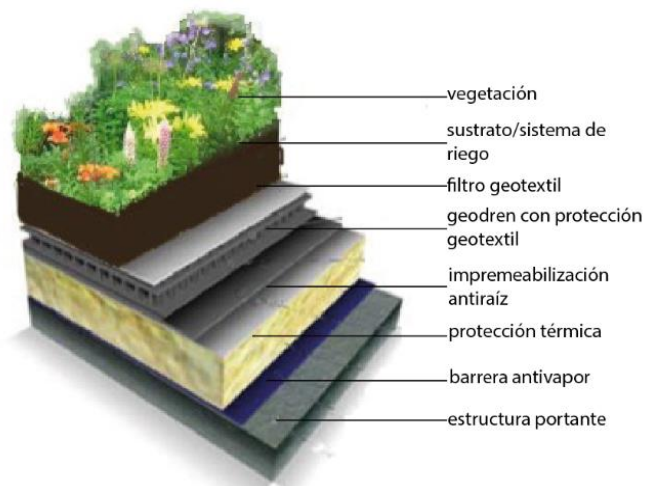
Figura 3. Sección de techo verde semi-intensivo
