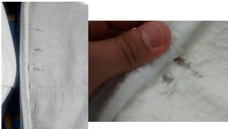
Figura 71. Filtros con remaches y con defectos
