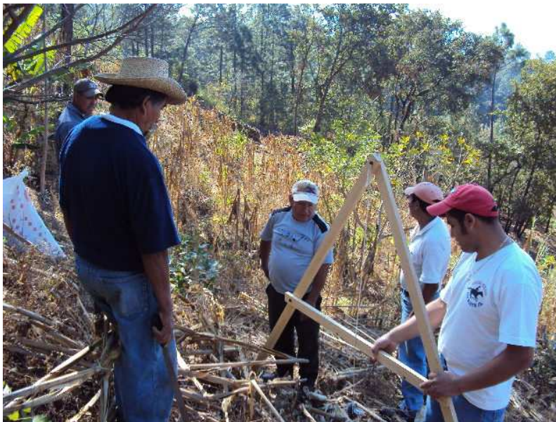
Figura 38. Demostración de nivel en "A"
