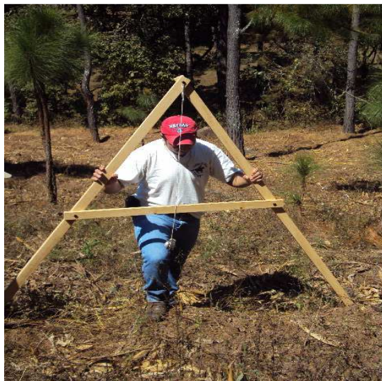
Figura 36. Nivel en "A" utilizado para realizar curvas de nivel
