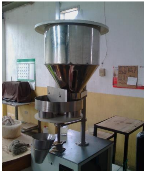
Figura 27. Dosificadora volumétrica de sólidos
