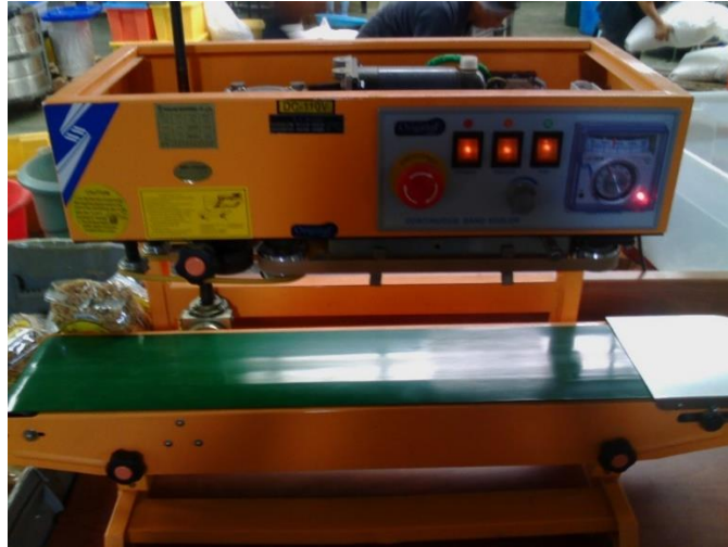
Figura 24. Selladora continua vertical
