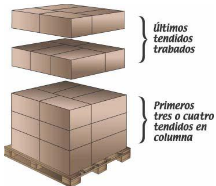
Figura 10. Recomendaciones para una correcta estiba (acomodo) de la carga en el pallet: • Método # 1:
