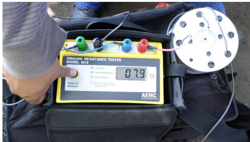
Figura 60. Registro de la resistencia del suelo en el megger
