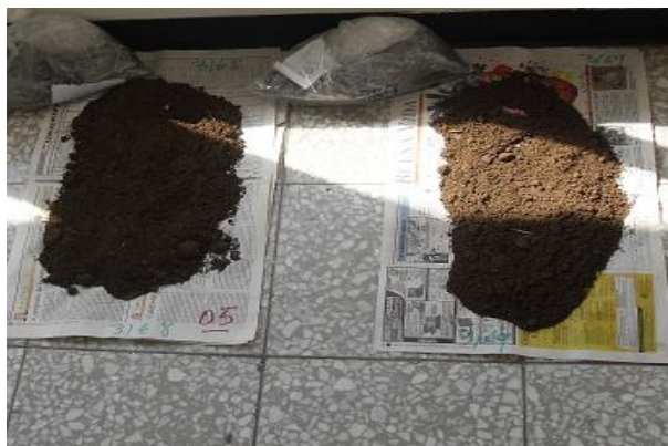
Figura 84. Preparación y secado del suelo. Fuente el autor
