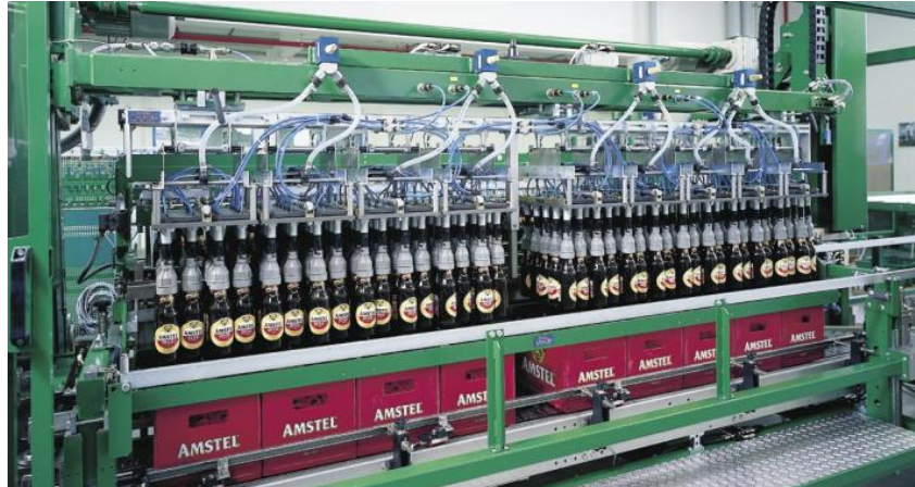
Figura 13. Ilustración de un proceso de encajonado
