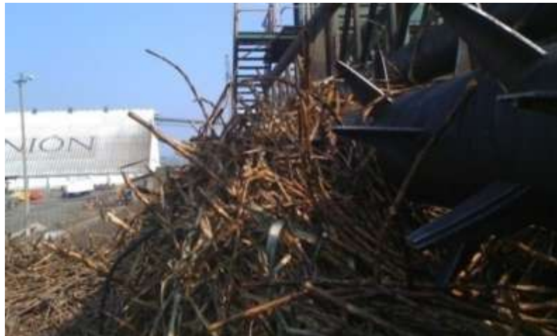
Figura 7. Eje giratorio en el proceso de lavado en seco.
