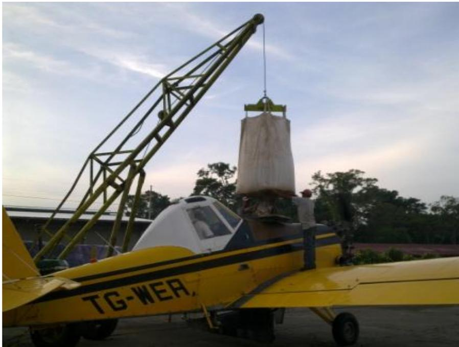
**Figura 32. Jumbo con sulfato de amonio está siendo descargado en la avioneta**
