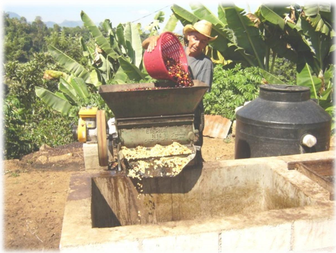
Figura 9. Despulpador de pequeño caficultor de La Democracia, Huehuetenango, accionado por motor de 2 HP y tanque plástico para almacenar agua.
