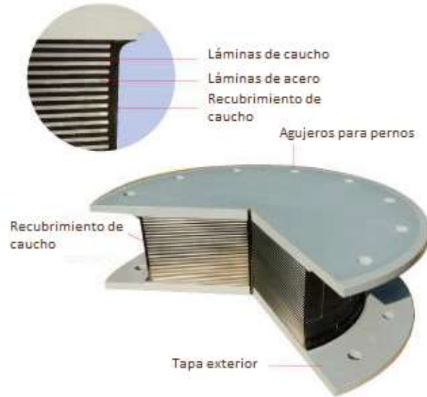
Figura 36. Detalles de aislador marca Bridgestone
