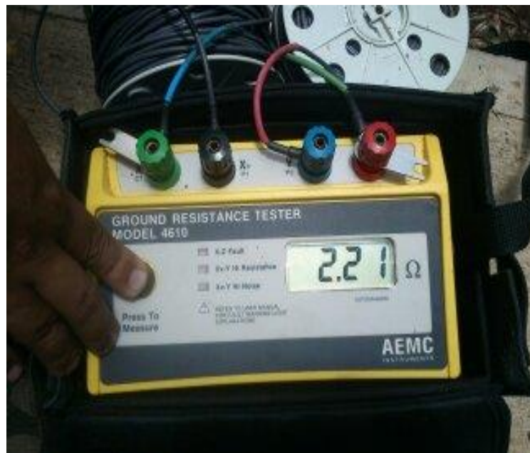
Figura 45. Fotografía del medidor de cuatro puntos método Werner
