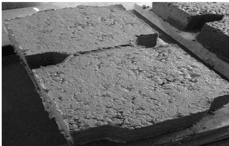
Figura 5. Muestra de adoquines con mezcla patrón
