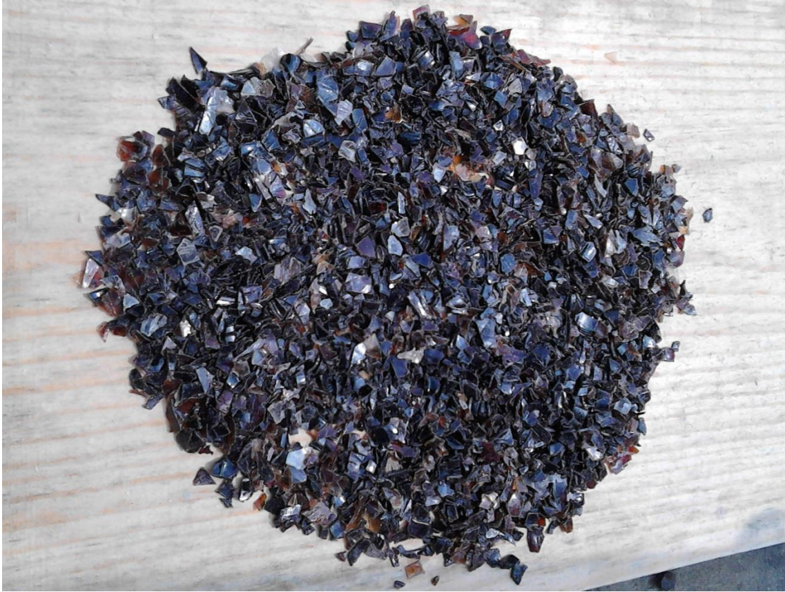
Figura 2. Material reciclado de PET, triturado en hojuela
