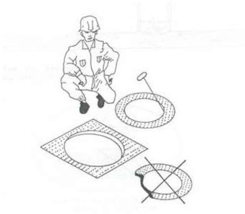
Figura 16. Reposición de tapaderas dañadas
