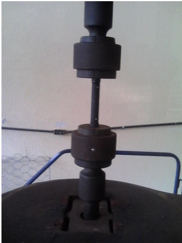
Figura 55. Ensayo de tensión
