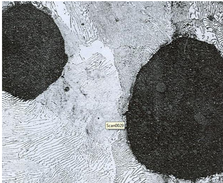
Figura 8. Microestructura fundición nodular perlítica 500X
