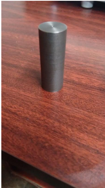
Figura 28. Probetas ensayo de compresión
