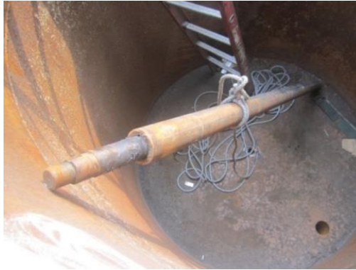
Figura 46. Eje utilizado para el agitador mecánico
