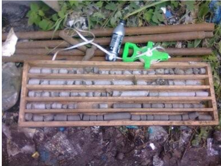
Figura 6. Muestra colocada en caja para traslado a laboratorio
