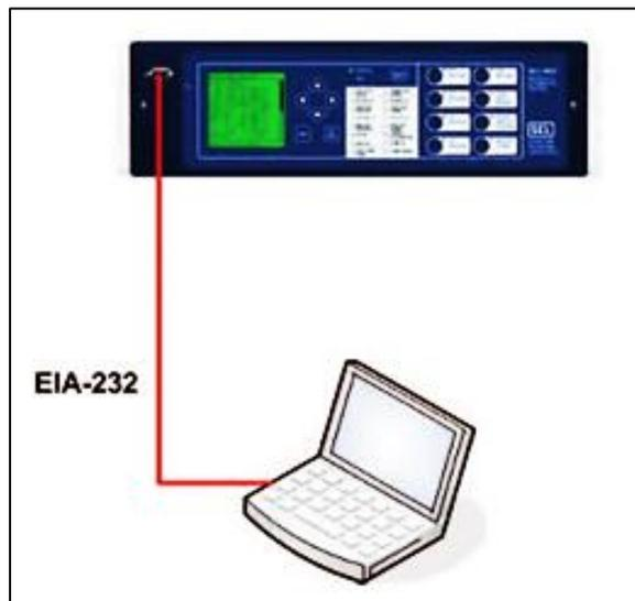
Fuente: *Sistema de protección, automatización y control de diferencial de línea avanzado.*
