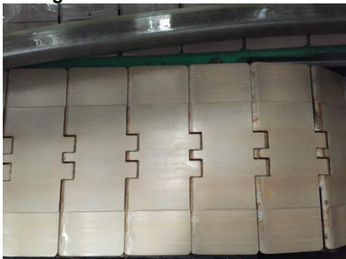
Figura 5. Tablillas en buen estado
