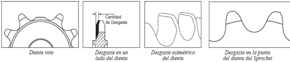
Figura 9. Fallas en sprockets
