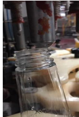
Figura 8. Válvula y envase desalineados
