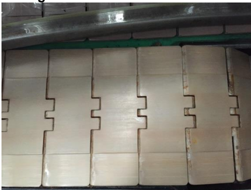
Figura 5. Tablillas en buen estado
