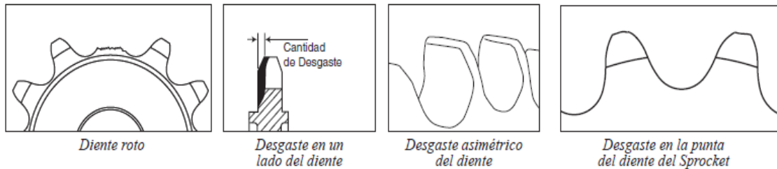
Figura 10. Fallas en sprockets
