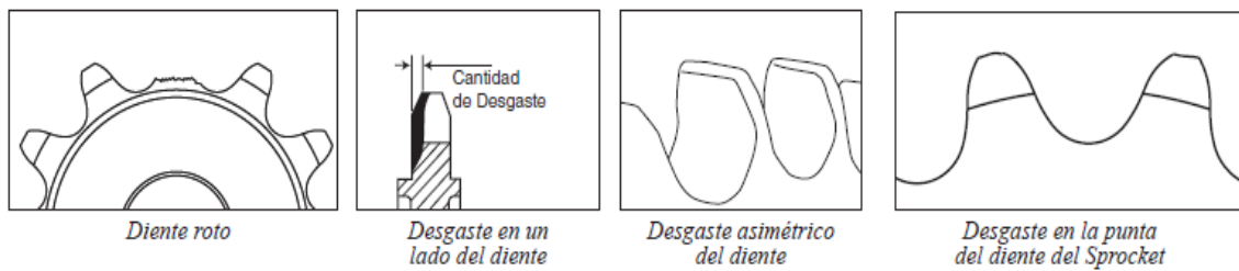
Figura 13. Fallas en Sprocket
