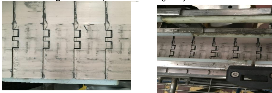
Figura 3. Limpiar suciedad de guías y tablillas
