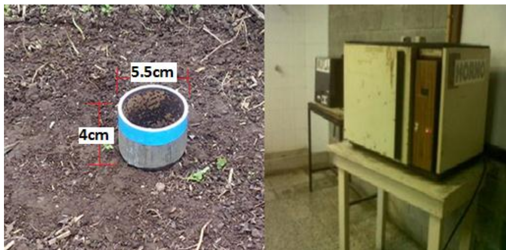
Figura 16: Cilindro para extracción de muestras de suelo que posteriormente se llevaron al horno.
