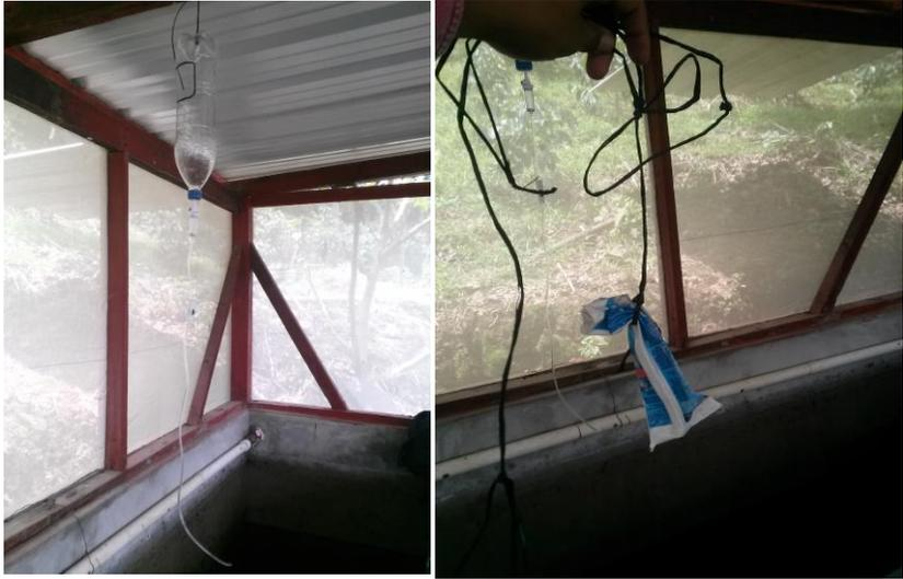
**Figura 12.** Reguladores para descarga de cloro.
