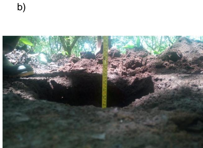
Figura 16: Recolección de la muestra de suelo. a) Excavación de agujero. b) Medición del agujero.
