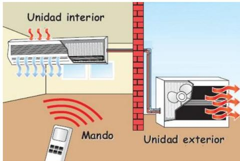
Sistemas separados o split system (Split en inglés: dividido o partido) o Mini Split se diferencian de los de ventana porque están repartidos o divididos en dos muebles, uno exterior y otro interior, con la idea de separar en el circuito de refrigeración la zona de evaporación en el interior de la zona de condensación en
