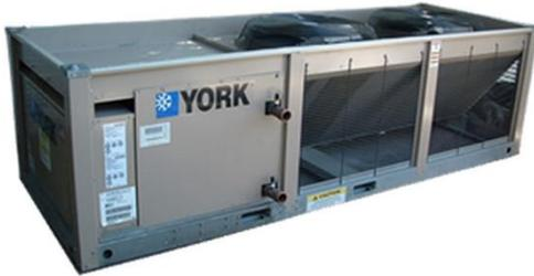
Los equipos de aire acondicionado tipo paquete tienen un diseño de fábrica en el cual todos sus componentes están integrados en un mismo cuerpo, es decir la condensadora y la evaporadora están juntas y este equipo debe instalarse al exterior por el motivo de una recuperación de aire ambiente y también para expulsar todo el calor de las zonas enfriadas.
