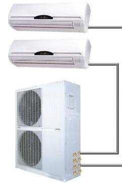
Sistemas multi split: consisten en una unidad condensadora exterior, que se puede vincular con dos o más unidades interiores. Se han desarrollado equipamientos que permiten colocar gran cantidad de secciones evaporadoras con solo una unidad condensadora exterior mediante la regulación del flujo refrigerante, denominado VRV. Todas estas unidades son enfriadas por aire mediante un condensador y aire exterior circulando mediante un ventilador.
