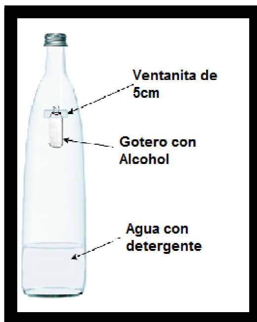
Figura 18. Estructura de una trampa con alcohol para el control de la broca del café.
