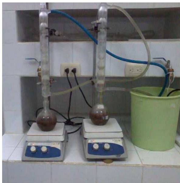
Figura 8. Sistema de maceración dinámica con reflujo
