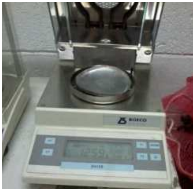
Figura 13. Medición de la humedad
