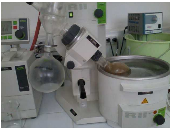
Figura 10. Concentración del extracto acuoso
