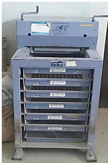
Figura 21. Ensayo de granulometría al agregado grueso según norma ASTM C-136
