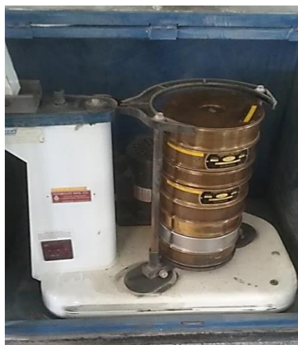
Figura 25. Ensayo de granulometría al agregado fino según norma ASTM C-136
