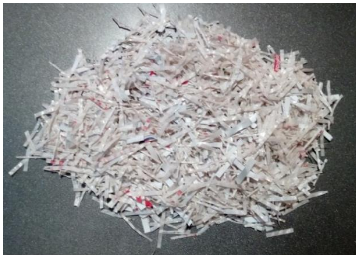
Figura 28. Tiras de polipropileno con dimensiones de 4 mm x 20 mm
