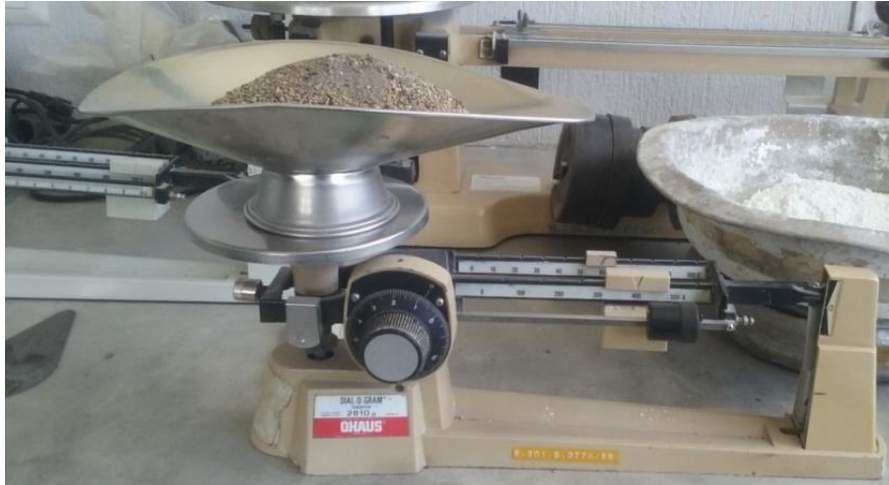
Figura 24. Ensayo de porcentaje que pasa el tamiz núm. 200, del agregado fino según norma ASTM C-117
