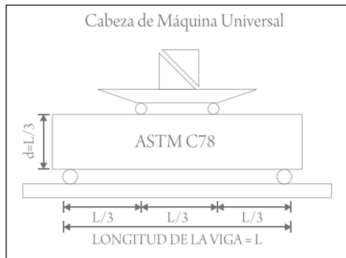
Figura 5. Determinación del módulo de ruptura según norma ASTM C78
