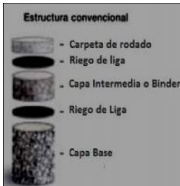
Figura 9. Estructura de mezcla asfáltica convencional
