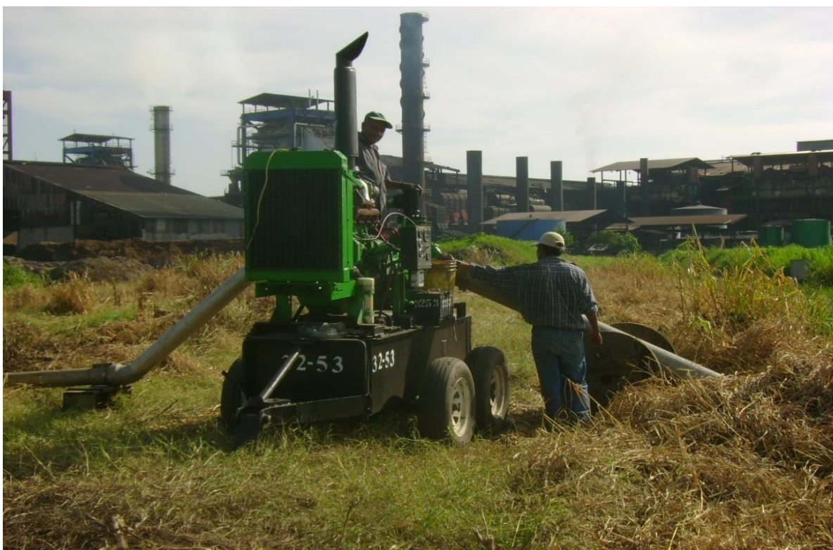
Figura 41A. Motobomba aspersion cañon y mini aspersion.
