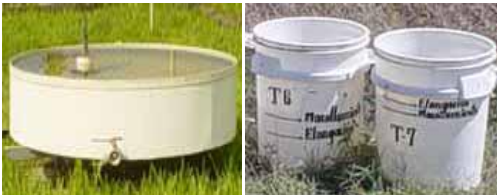
Tanque Tipo "A".
