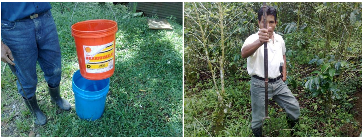
Figura 20. Recipientes y barreno utilizados para la extracción de muestras. Para cada punto establecido para muestrear se realizó una limpia con machete y con azadón para evitar que se contaminara la muestra.
