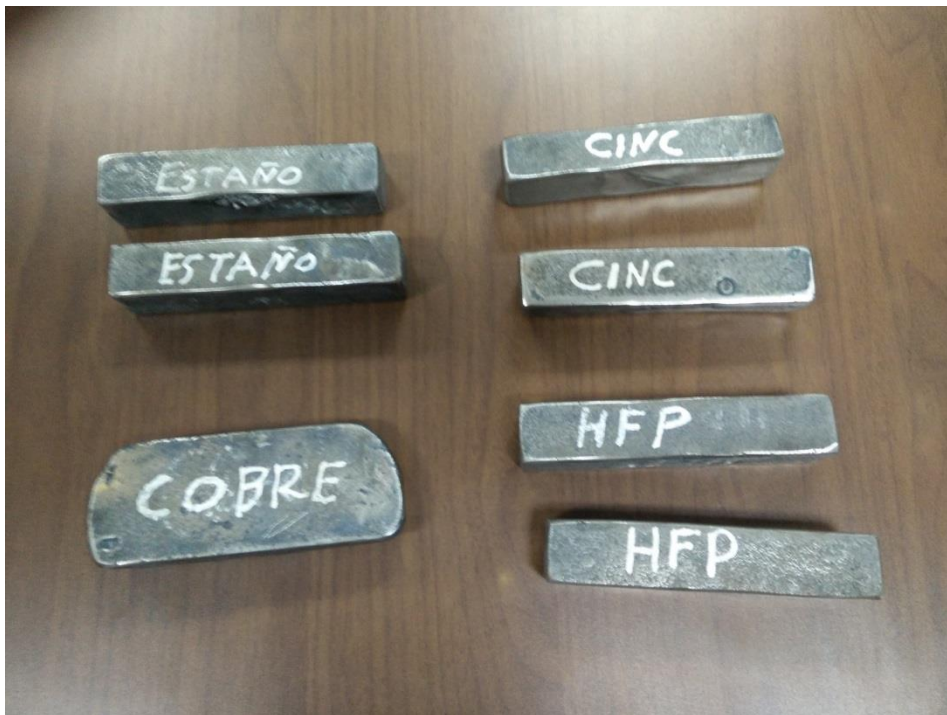
Figura 19. Probetas ya maquinadas
