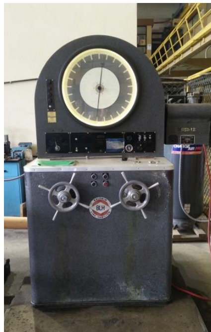
Figura 8. Máquina universal del ensayos Baldwin
