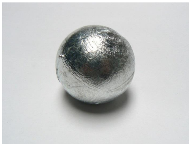
Figura 14. Ánodo de zinc puro
