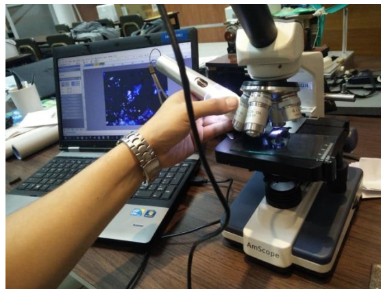
Figura 21. Cámara especial tipo ocular para microscopio
