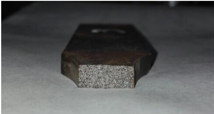
Figura 20. Fractura de fundición gris
