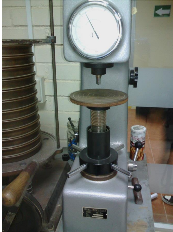
Figura 25. Medición de dureza con máquina Rockwell Hardness Tester modelo HR-150A
