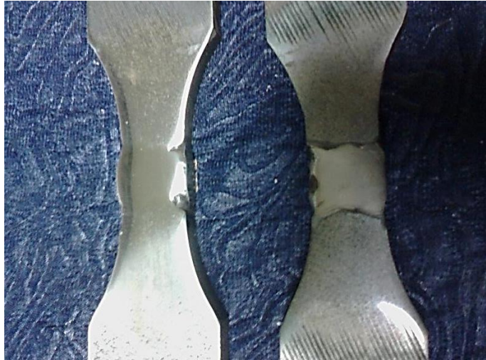
Figura 27. Preparación de pieza , izquierda probeta pulida, derecha atacada químicamente
