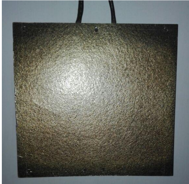
Figura 16. Resistencia de 900 watts que alcanza los 400° C
