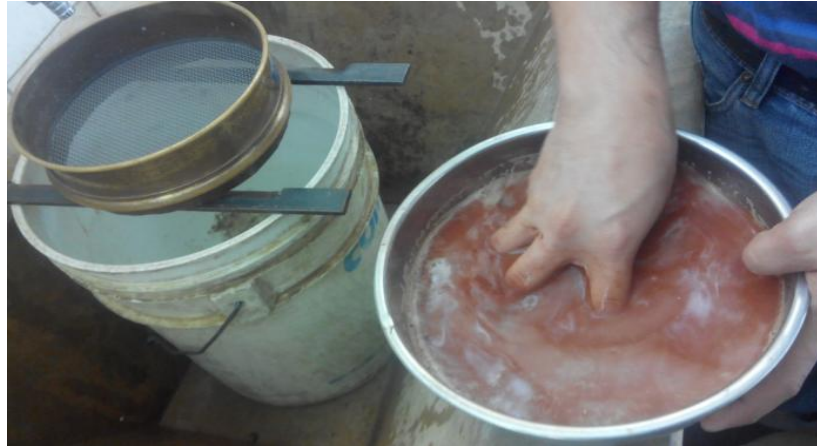
Figura 1. Agregados por método de desplazamiento de agua
