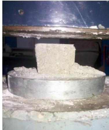
Figura 2. Ensayos cubos a compresión
