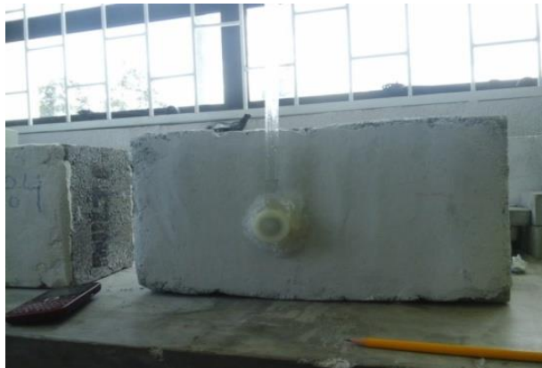
Figura 21. Ensayo de permeabilidad
