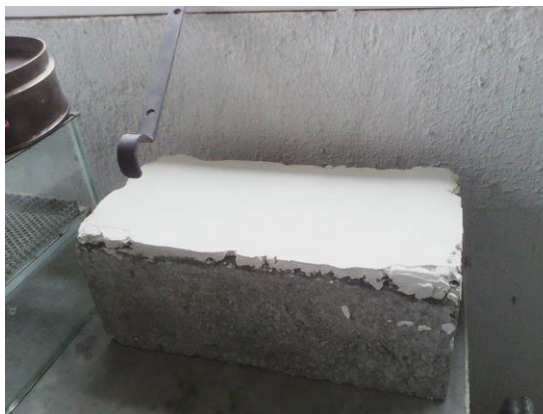
Figura 18. Block recubierto con mortero de feldespato y cemento blanco
