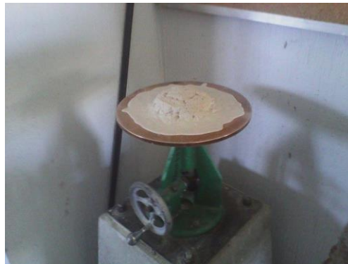
Figura 13. Ensayo de flujo o manejabilidad del mortero
