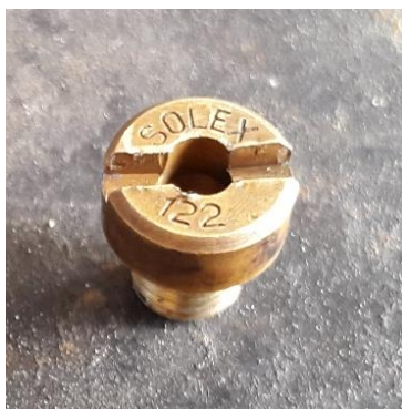
Figura 28. Aguja principal de carburador solex H30/31
