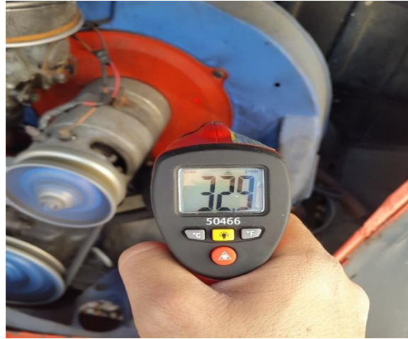
Figura 34. Temperatura base de ventilador de enfriamiento
