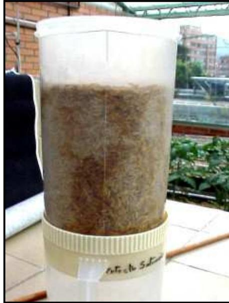
**Figura 4.** **Canalización del agua en la cascarilla de arroz.** Al agregar agua por encima a la cascarilla de arroz, esta se "canaliza" y se producen zonas muy húmedas al lado de zonas muy secas. Tomado de Calderón (2002).
