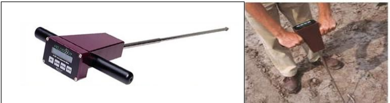
Figura 27: Medidor digital de compactación del suelo y forma de utilizarlo en el campo.
