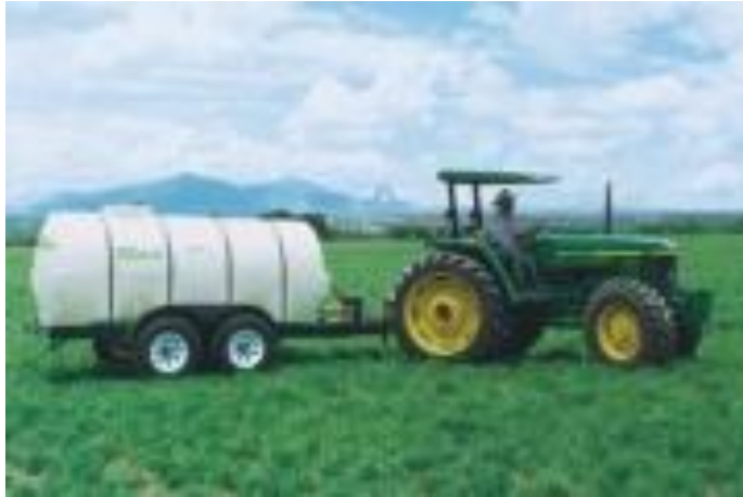
Figura 4: Vista de tanque agroquímico acoplado a un tractor.
