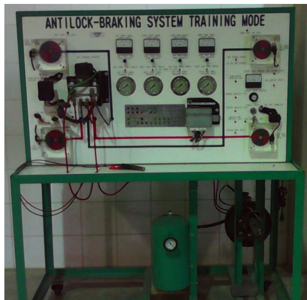
Figura 17. Módulo de simulación del sistema de antibloqueo de ruedas (antilock brake system, ABS)
